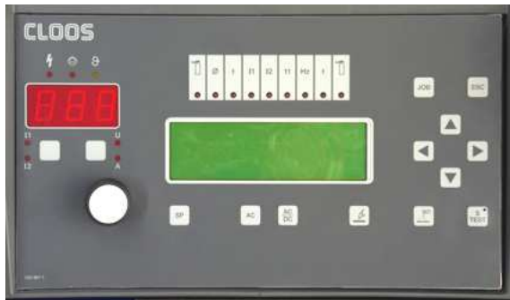
4. ábra CWS 100 jelű, nyomógombos kezelőpanel
