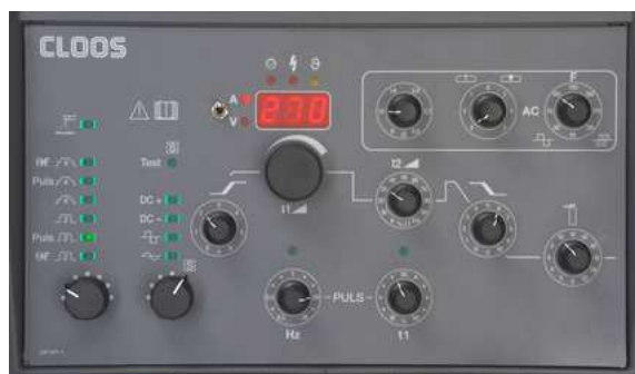
3. ábra Hagyományos forgatógombos kezelőpanel
